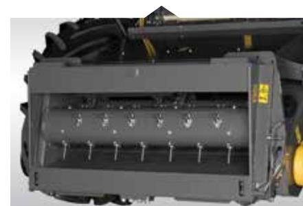
El cilindro de alimentación PFR situado en la parte frontal del elevador de cultivo principal logra un flujo de cultivo consistente desde el cabezal hasta el elevador. Puede invertirse de manera sencilla y efectiva desde la cabina.
