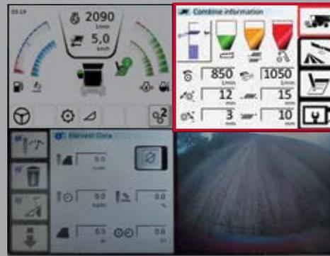
El **menú principal de la cosechadora** es fácil de leer e indica la altura real y deseada del cabezal, la pérdida de grano de los sacudidores y cribas y el volumen de retorno. Muestra la altura del cabezal, velocidad del cilindro, apertura frontal y trasera del cóncavo, velocidad del ventilador, y la apertura superior e inferior de las cribas. Las teclas de acceso directo en los iconos permiten el ajuste rápido de estas configuraciones.
