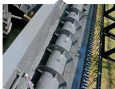
Los dedos del sinfin de anchura completa del cabezal FreeFlow aumentan el rendimiento y aseguran la alimentación rápida y continua del elevador de cultivo principal.
