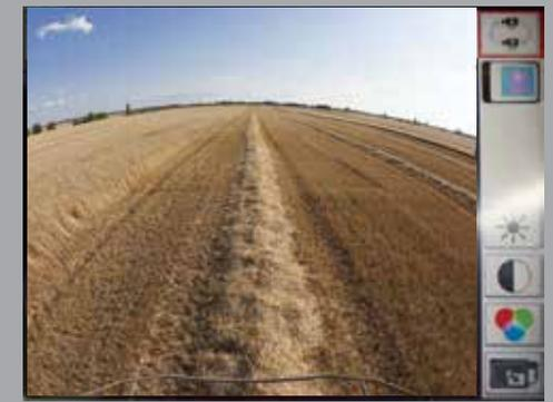
Las ventanas del terminal muestran hasta dos **cámaras traseras** en la parte inferior. El operador puede decidir tener la vista de las cámaras en pantalla de continuo o bien solo cuando se da marcha atrás, por ejemplo. La imagen puede aumentarse de tamaño para mostrar todos los detalles con tan solo pulsar un botón.
