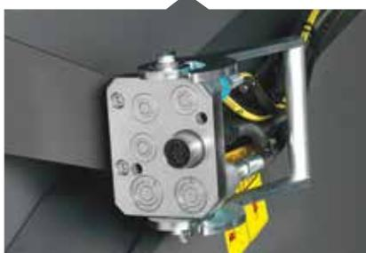
Multiacoplador combinado estándar para el desmontaje rápido del cabezal.
