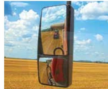
Flexibilidad con espejos seccionados
