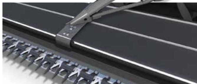
La cuchilla sobresale un impresionante 1,14 m del sinfín del cabezal, optimizando su visibilidad y el rendimiento. Las resistentes lonas PowerFlow llevan el cultivo de la cuchilla hasta el elevador principal a una velocidad constante. Las lonas también desvían las piedras que podrían entrar en la máquina y causar daños.
