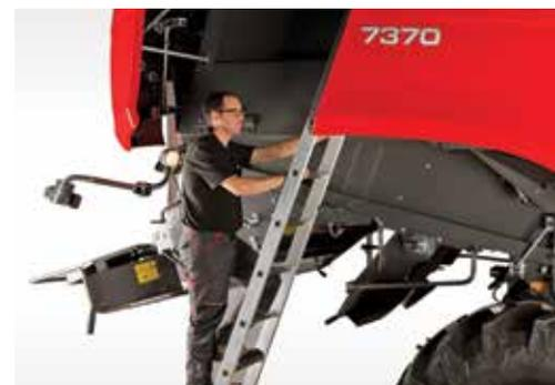
Acceso seguro al compartimento del motor y al depósito de grano mediante una escalera extraíble
