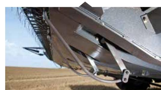
El control del cabezal AutoLevel es estándar con control automático de la altura del cabezal. Precisa transición de un lado a otro que mantiene constante la altura de corte. Junto con la característica de velocidad del molinete automática, facilita el control del cabezal.
