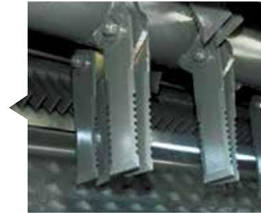
Una placa horadada ajustable de serie para asegurar que la paja se corte de forma consistente.
