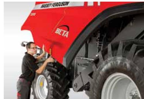
Los paneles de una pieza disponen de luces que facilitan la inspección
