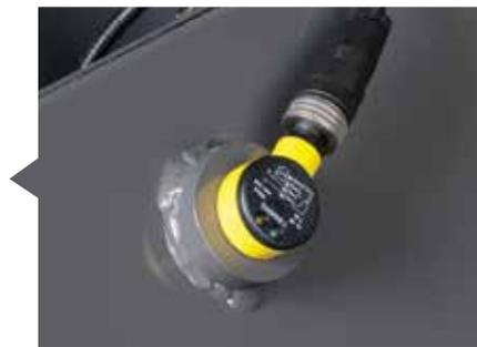
Un sencillo sensor de retorno muestra el volumen en la cabina y permite los cambios rápidos para mejorar la muestra.
