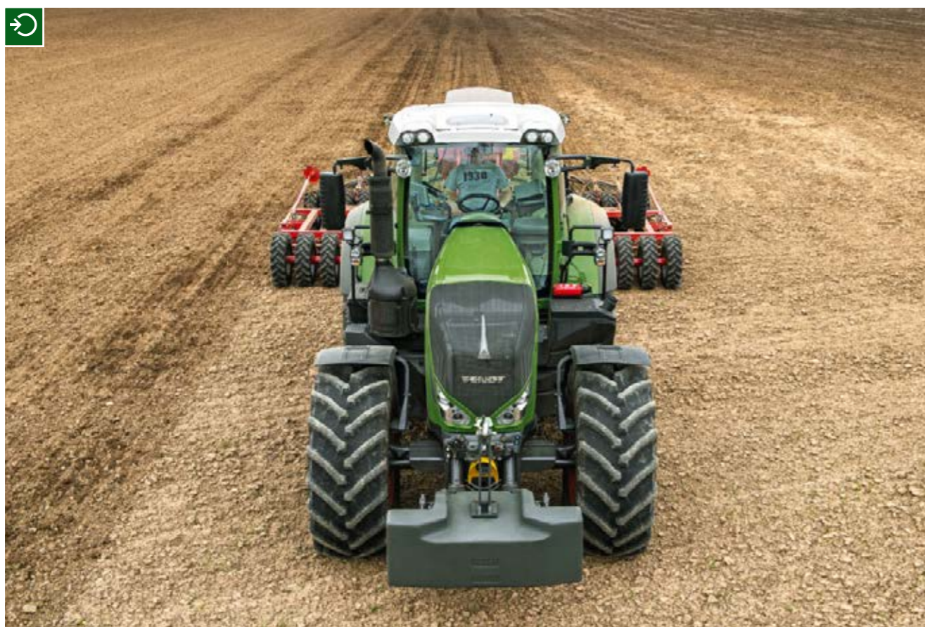
El Fendt 800 Vario ha sido adaptado para ofrecer una vista panorámica óptima. El diseño del capó se ha mantenido lo más estrecho posible para que el conductor disfrute de una excelente visión de los pasos de rueda y de los aperos montados en la parte delantera.
