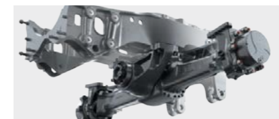
■ El elegante semibastidor fundido del Fendt 300 Vario constituye una robusta base para todo el tractor: el motor, la unidad de refrigeración, el elevador delantero, la toma de fuerza delantera y el eje delantero están montados en el semibastidor. Gracias a esta construcción estable, se admiten cargas por eje más grandes. El elegante diseño permite un mayor ángulo de giro.
