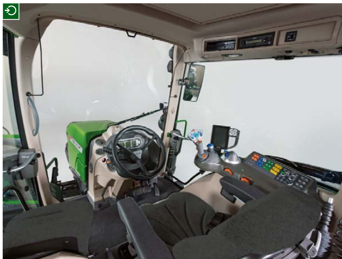
La cabina VisioPlus, con una distribución clara y un diseño ergonómico, ofrece la máxima visibilidad tanto de los elementos de mando como del campo. El parabrisas está disponible en forma de luneta panorámica continua o como luneta abatible. Puede elegirse una puerta adicional en el lado derecho de la cabina.
