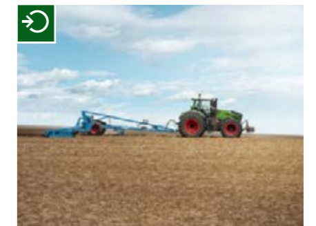
Gracias al sistema de gestión del tractor TMS y a la regulación automática de carga límite 2.0 el tractor adapta las revoluciones del motor de modo óptimo a la velocidad de conducción.
