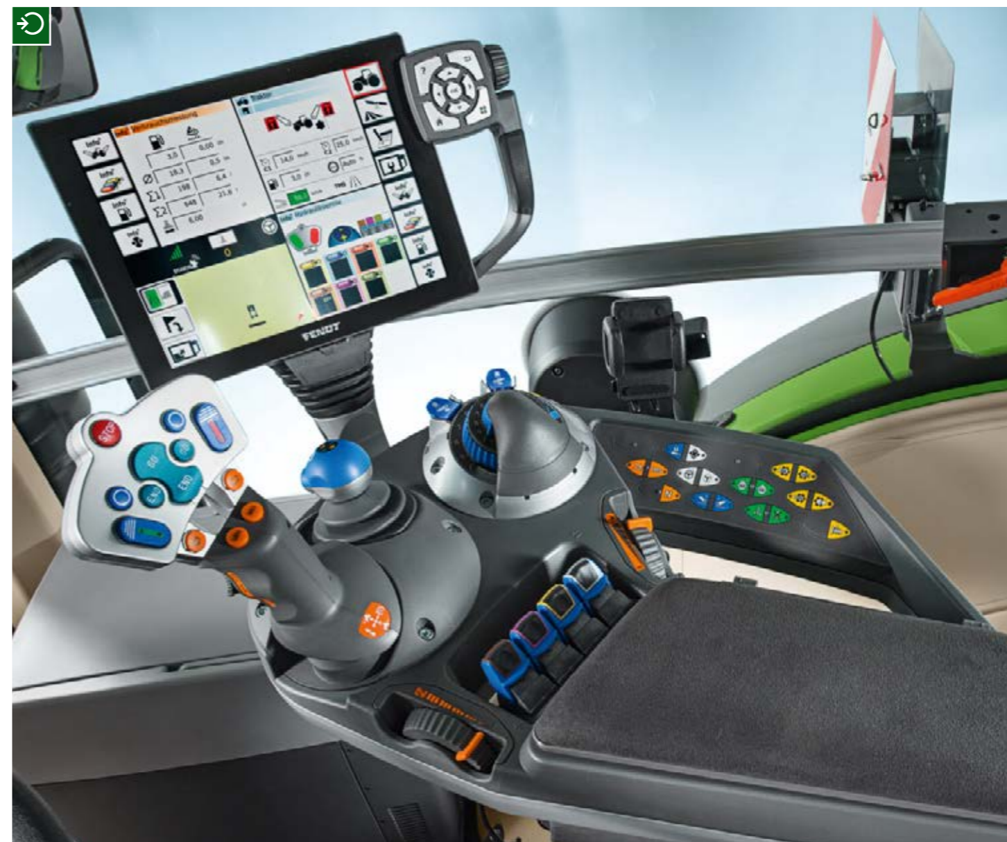
El centro de mando ergonómico, compuesto por un terminal Vario 4 en 1, un joystick multifunción, palanca en cruz, un módulo de elevación EPC, el control de las válvulas y un teclado de láminas, permite acceder a todo lo necesario.
