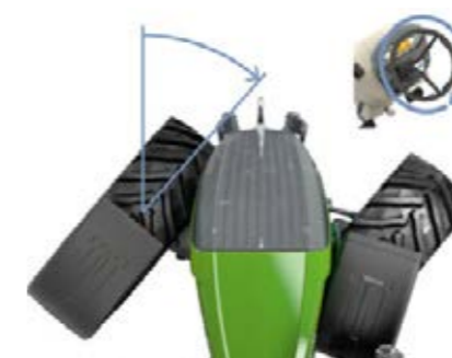
VarioActive permite conseguir un giro completo con solo un movimiento del volante.
