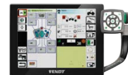
El control del apero Variotronic permite gestionar los aperos aptos para ISOBUS directamente con un joystick o a través del terminal Vario.
