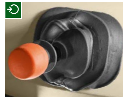
Asistente de freno de mano en posición automática: El freno de mano se activa de forma automática.
