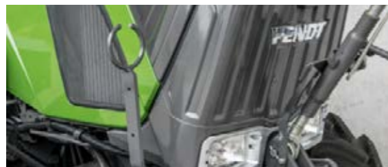
□ Los latiguillos hidráulicos están siempre ordenados y organizados gracias a las sujeciones a ambos lados.
