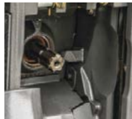
■ Los ejes de la TdF se acoplan con facilidad gracias al perfil biselado y modificado.
