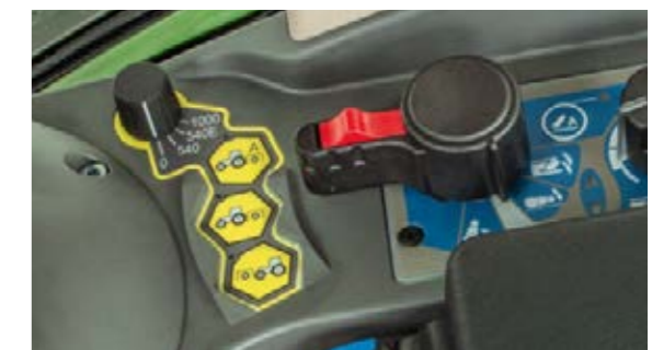
Práctico interruptor confort de la TdF con función automática en el reposabrazos.
