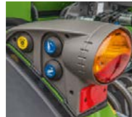
■ Los controles externos para el sistema hidráulico y la TdF están situados en los guardabarros traseros.
