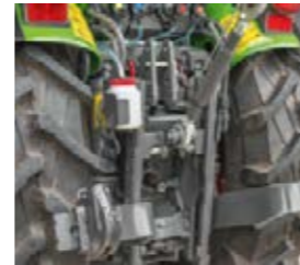
□ Con la extracción curva, el apero no se arrastra por el suelo en pendientes cuando se entra en una hilera.
