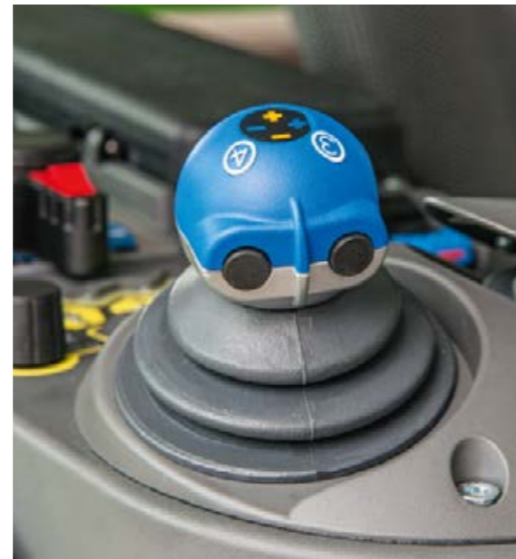
■ El tercer y cuarto circuito de control se activa cómodamente con un pulsador o interruptor en la palanca monomando en cruz.
