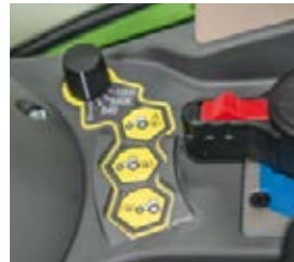
■ La velocidad requerida de la TdF puede seleccionarse cómodamente mediante el mando giratorio.
