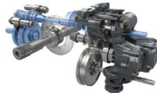
La transmisión directa de la TdF garantiza una excelente eficiencia. La velocidad se reduce directamente en el eje de la TdF.
