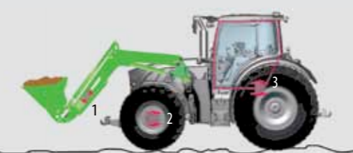
Cargador frontal con sistema de amortiguación: Los depósitos de presión de gas actúan como amortiguadores de oscilaciones e impiden que las vibraciones se transmitan al tractor. El sistema de amortiguación integrado (1), junto con la suspensión del eje delantero (2) y la suspensión de la cabina (3), garantiza una excelente comodidad de conducción (opcional).
