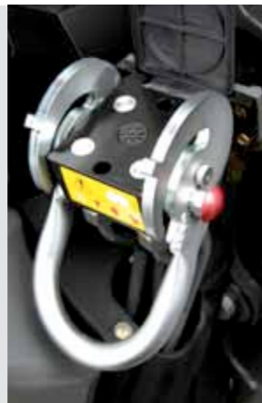
Un multiacoplador conecta todos los conductos hidráulicos y eléctricos al mismo tiempo, incluso con presión en el lado del cargador frontal.
