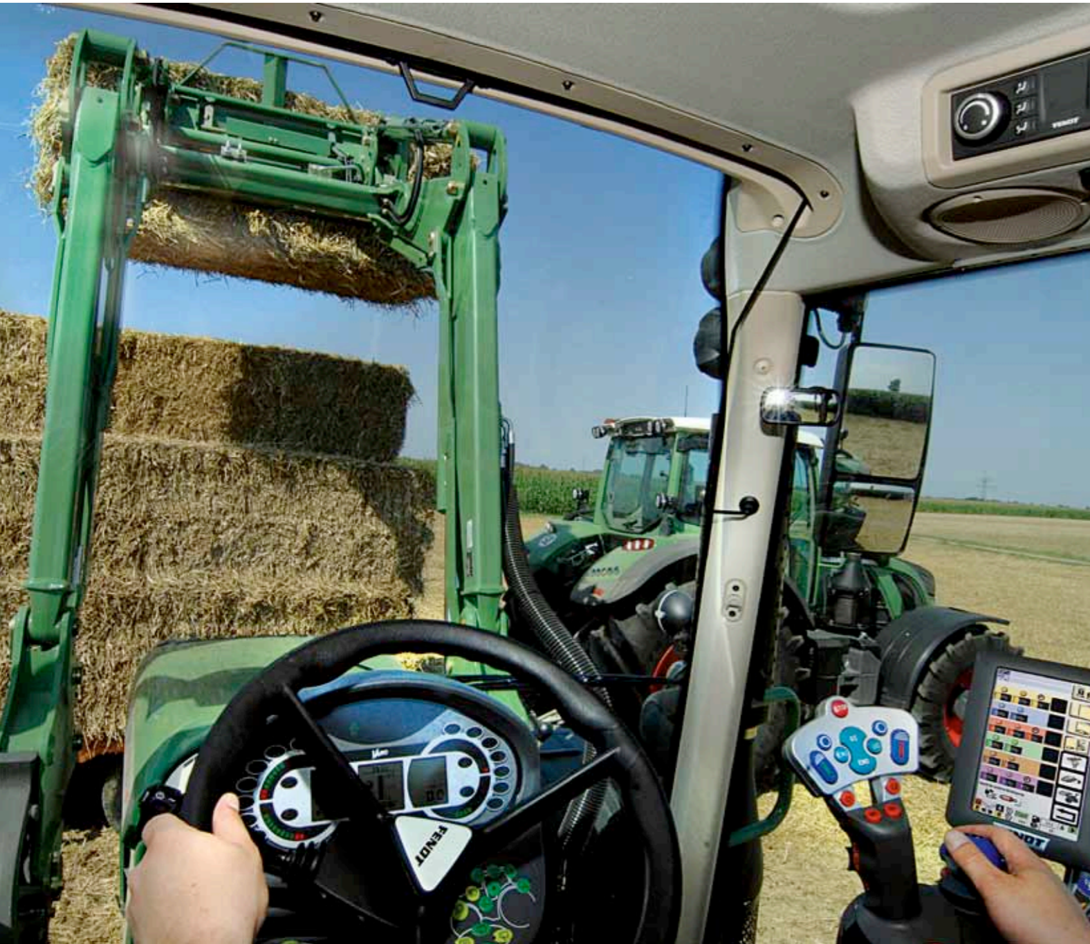
Cargador frontal sin sistema de amortiguación: Las oscilaciones se transmiten al tractor.
