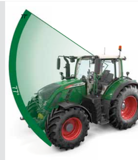
La ventana de techo, que se incluye de serie en el 200 Vario, ofrece una visibilidad óptima del cargador frontal cuando está elevado.
