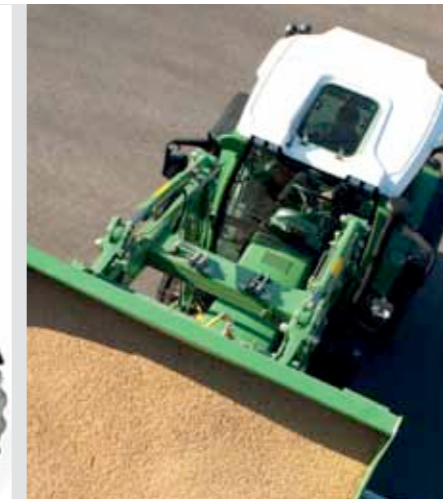
La ventana de techo, que se incluye de serie en el 200 Vario, ofrece una visibilidad óptima del cargador frontal cuando está elevado.
