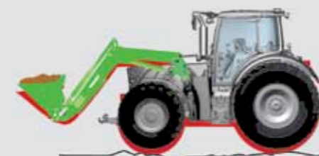
Cargador frontal sin sistema de amortiguación: Las oscilaciones se transmiten al tractor.
