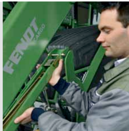
Los soportes de la pala con autoajuste están montados de forma compacta en el brazo.
