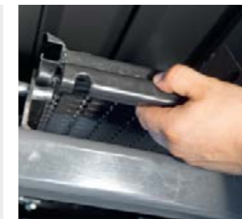
Extracción de las cribas
