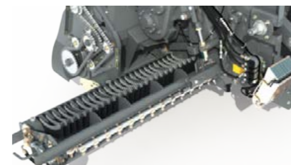
El bastidor inferior donde se alojan las cuchillas de corte puede extraerse desde el lado izquierdo de la máquina para el reemplazo de las cuchillas.
