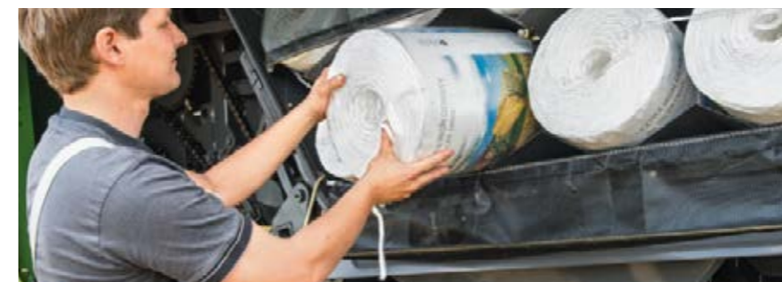
El almacenamiento ligeramente inclinado de la cuerda permite un rápido y fácil llenado.
