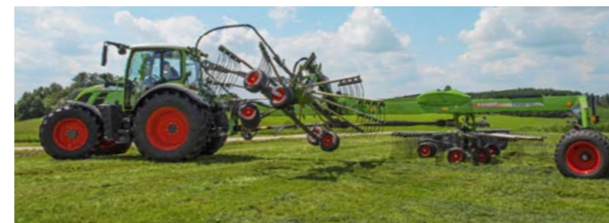
El control secuencial siempre eleva el rotor del rastrillo hilerador Fendt Former en la cabecera por el orden idóneo.
