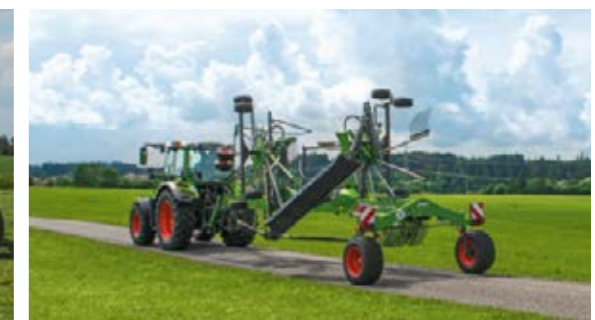
El rastrillo de hilerado lateral de dos rotores Fendt Former también se puede transportar por carretera de forma rápida y segura, y plegarse formando una unidad compacta.
