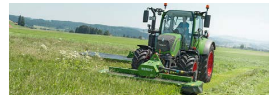
La Fendt Slicer 310 FPK se monta muy cerca del tractor y es extremadamente maniobrable gracias a su especial enganche oscilante.
