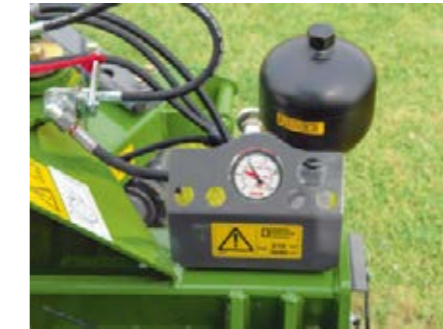
La descarga hidroneumática de la barra de corte TurboLift proporciona un corte flotante único.
