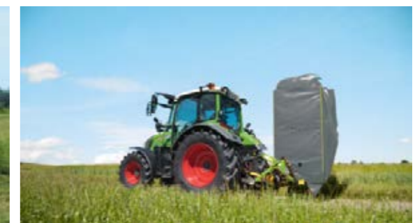
Cambie de la posición de funcionamiento a la posición de transporte compacta desde la cómoda cabina del tractor.
