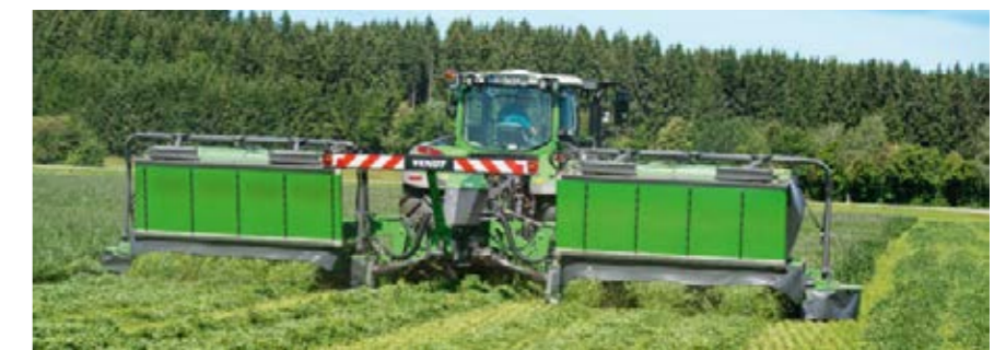
Con tan solo pulsar un botón, las cintas pueden plegarse hacia arriba y el material de cosecha puede descargarse por toda la anchura.
