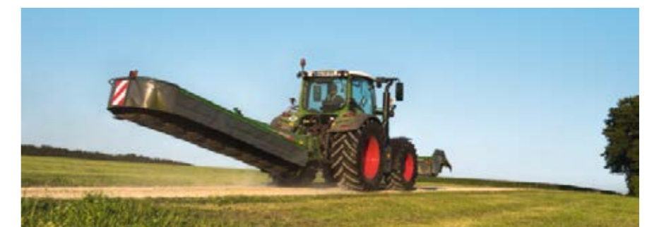
La segadora puede girarse hasta 90° hacia la parte trasera desde la cabina cuando esta se encuentra en la posición de transporte.
