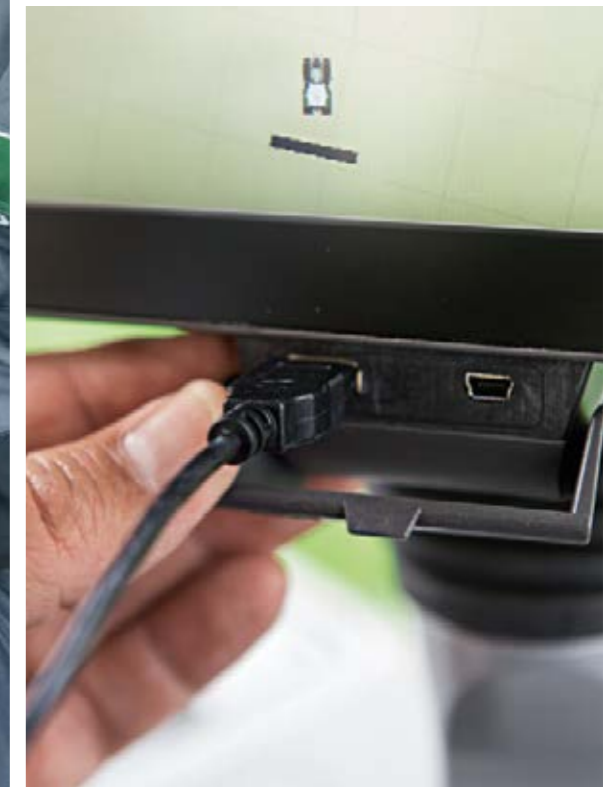
Los ajustes del campo pueden transferirse a otros tractores Fendt a través del puerto USB. El puerto para cargar teléfonos móviles es también muy práctico.
