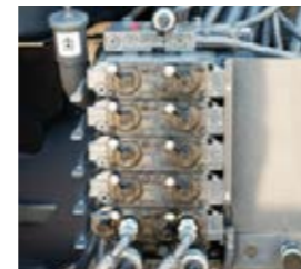
■ En la parte trasera se encuentran seis válvulas hidráulicas, una conexión de retorno y la línea PowerBeyond.
