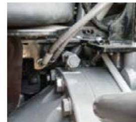
■ El motor está montado de forma amortiguada.
