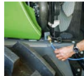
□ En la parte delantera hay una conexión de aire comprimido para limpiar el radiador.
