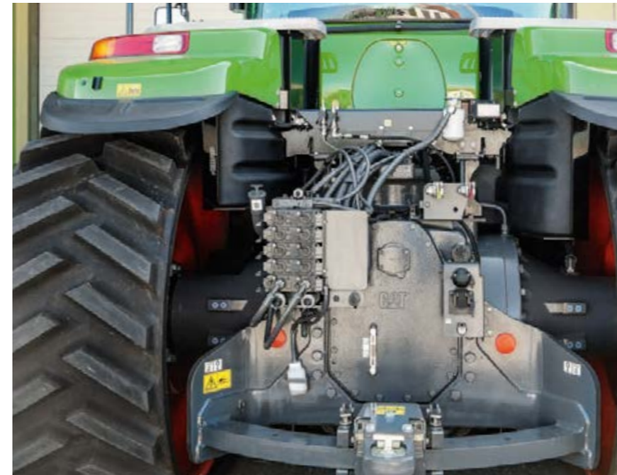
La barra de tiro, con dirección hidráulica de hasta 28° a cada lado, controla perfectamente los aperos.
