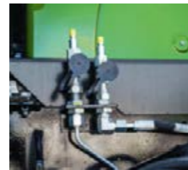
■ Las conexiones de presión para tensar las orugas son fácilmente accesibles.
