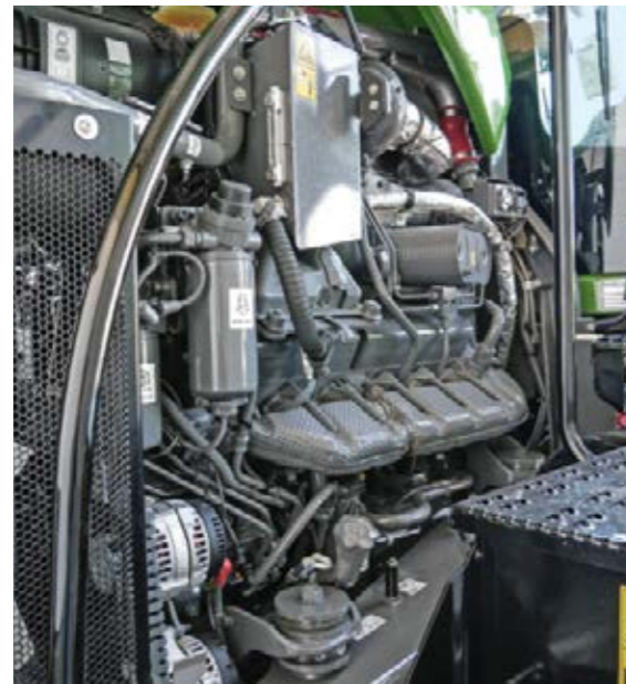
■ El motor de 12 cilindros de AGCO Power sorprende por su suave funcionamiento y buen acceso para el mantenimiento.
