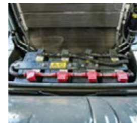
□ Cuatro baterías exentas de mantenimiento abastecen al Fendt 1100 MT.
