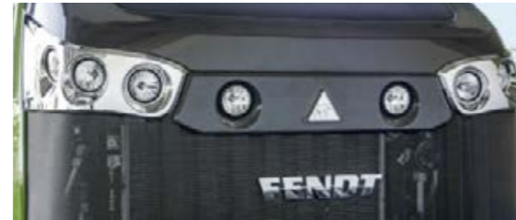
■ El entorno de trabajo está perfectamente iluminado en la parte delantera y en los laterales. Hay disponible faros LED bajo pedido.
