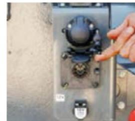
□ Hay una conexión de 12 V disponible en la parte trasera para consumidores externos. La conexión ISOBUS establece conexión con los aperos.
