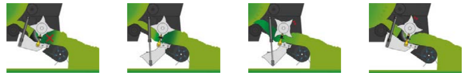
En el caso de producirse un bloqueo, la parte trasera de la base de corte baja 500 mm.
