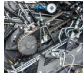
■ La cantidad de aceite que debe utilizarse para lubricar las cadenas puede ajustarse de forma individual.
