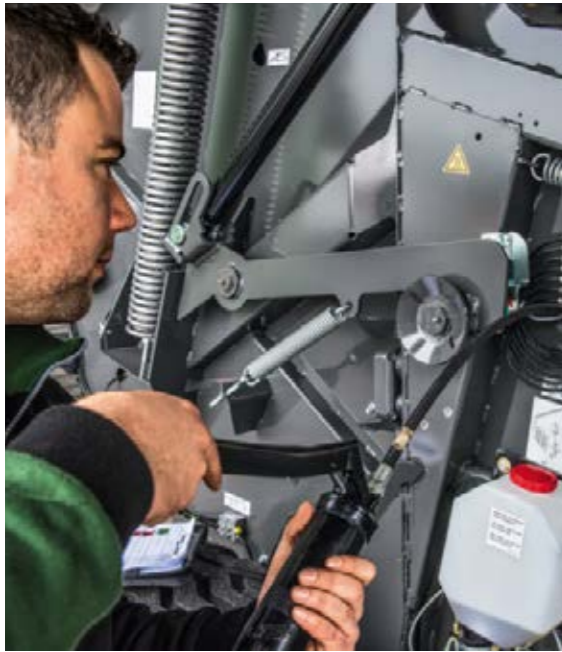
■ Los puntos de lubricación se centralizan aquí en una barra de lubricación, lo que permite lubricar el sistema más fácilmente.
