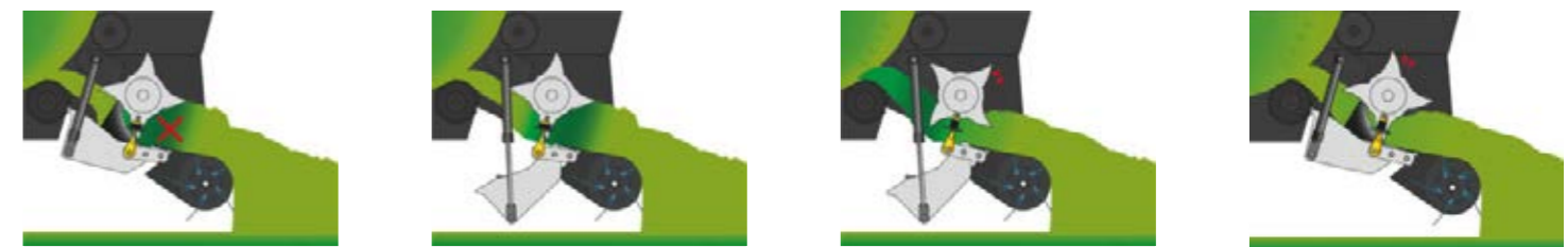
En el caso de producirse un bloqueo, la parte trasera de la base de corte descienda 500 mm.
