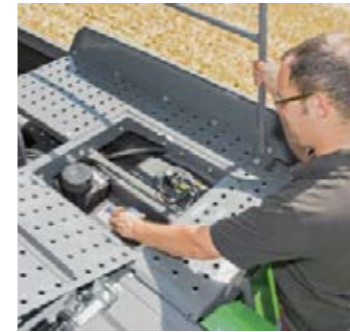
Llenado de combustible
