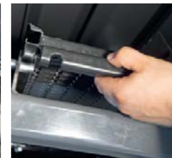
Retirada de las cribas
